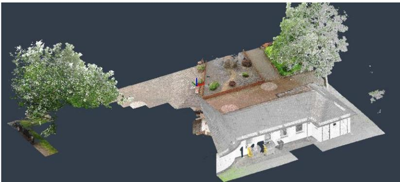
Die Punkte der Punktwolke sind in sogenannte „Voxel“ unterteilt. Diese sind logische Einheiten (ähnlich wie die Felder auf einem Schachbrett), und jeder Voxel enthält die in ihm positionierten Punkte.
